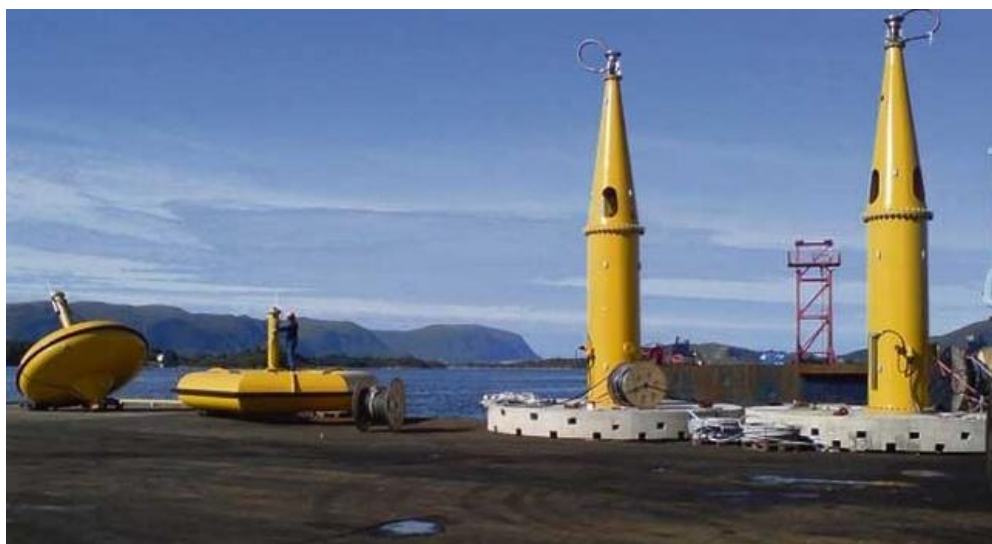
2.24.attēls Zviedrijas viļņu enerģijas elektrostācijas turbīnas 4
