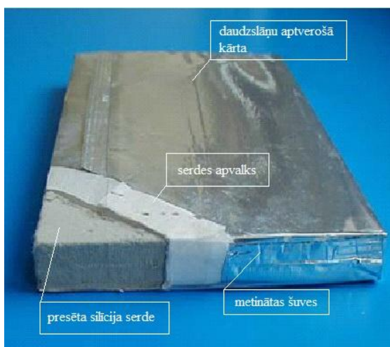
2.26.attēls. Vakuuma siltumizolācijas paneļa uzbūve
